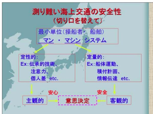
ています。その「マン・マシンシステム」のマシンの部分ですが、定量的に評価がしやすいという側面があります。例えば、船体がどう運動するかという事に関してはすでに研究が尽されていて、大体計算通りに答えを導くことが出来るような状況になっています。また、どこにどのような荷物を積みばどう喫水が変わるのかという内容も当然のことですし、情報につきましても AIS が普及する昨今では、完全に近い状況で相手船の諸情報が手に入るようになっています。従って、マシンの部分におきましては比較的客観的に安全を推し量ることが出来るようになりました。
